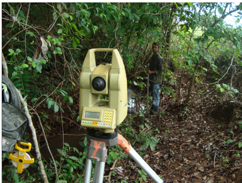
Figura 10. Estação Total utilizada no levantamento planialtimétrico.
