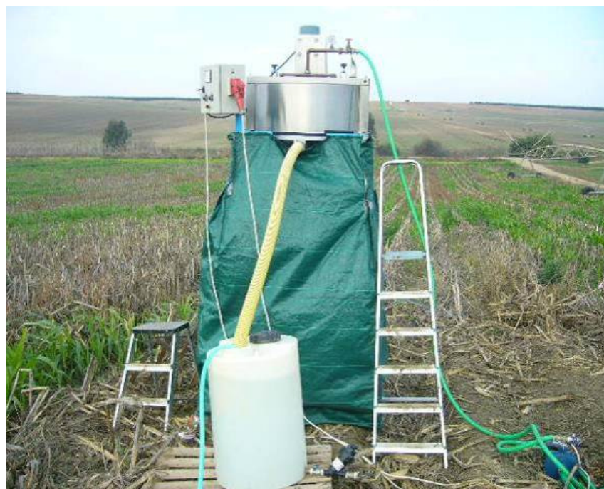
Figura 6. Esquema e foto do Simulador de chuvas portátil. Figura a – Visão geral do InfiAsper2, onde: (1) motor; (2) aplicador de água; (3) parede bloqueadora; (4) armação para sustentação do simulador; (5) coletor de água; (6) bomba hidráulica; (7) Fluxo de água sobre o solo; (8) tanque; (9) cano para coleta do excesso de água; (10) painel de controle elétrico. Figura b – Simulador de chuva instalado no campo. Fonte: Alves Sobrinho (2002, 2008)
