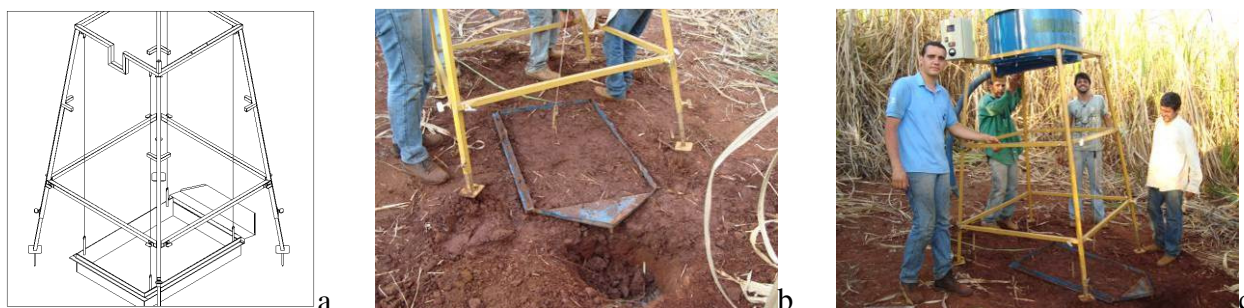
Figura 13. Demonstração do procedimento com o simulador de chuva no campo.
