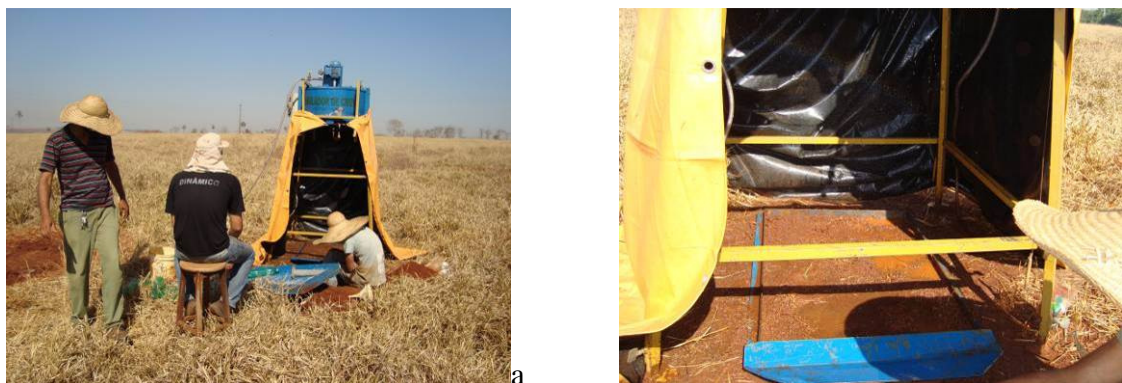
Figura 14. Simulador de chuva em operação (a) em um dos perfis – Área de pastagem (b) na microbacia.
