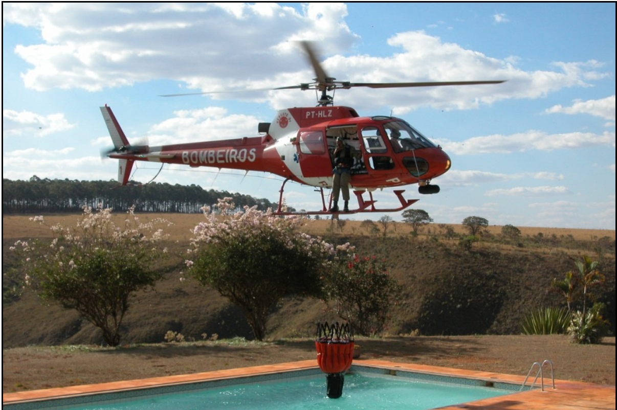
Figura 8: Resgate 01 – helicóptero, modelo: AS 350BA , propriedade do CBM-DF, utilizando a captação de água com o bolsa de água - bambi bucket de 500 litros. Fonte: arquivo do CBMDF
