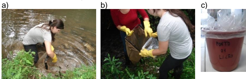
Figura 6- a) recolhimento do material bentônico com Surber . b) recolhimento do material em saco plástico. c) balde identificado com o saco plástico contendo a amostra.
