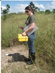
Figura 10 - Medição de gás metano a 1m acima da superfície do solo.
