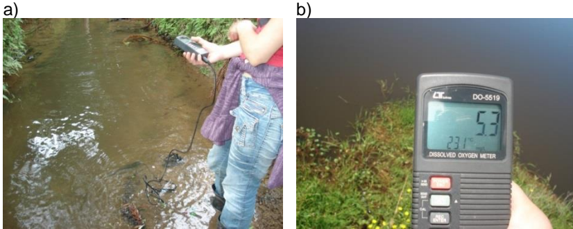
Figura 4 - a) medição do oxigênio dissolvido e da temperatura. b) medidor eletrônico de oxigênio dissolvido.
