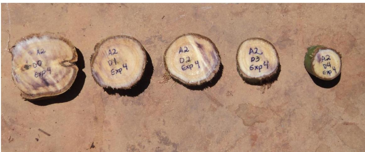
Figura 5. Amostras identificadas para determinação de densidade.
