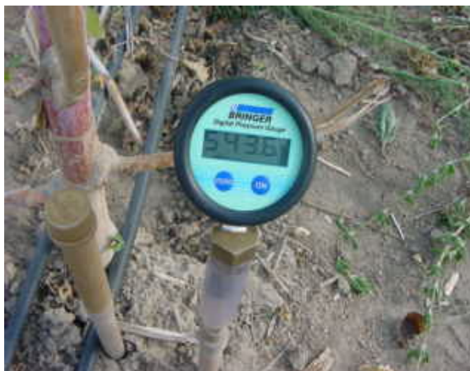
Figura 5. Tensímetro de punção em campo. Pesqueira-PE, 2007
