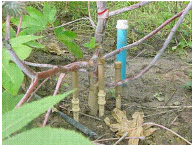
Figura 7. Estação tensiométrica junto com tubo de acesso para Sonda de Nêutrons. Pesqueira-PE, 2007.
