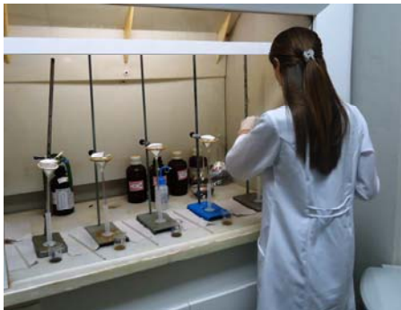
Figura 11 – Ataque Ácido com Ácido Clorídrico
