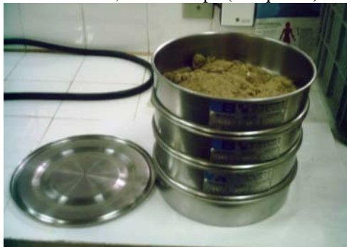
Figura 7 – Conjunto de peneiras de aço inoxidável, com a tampa (à esquerda)
