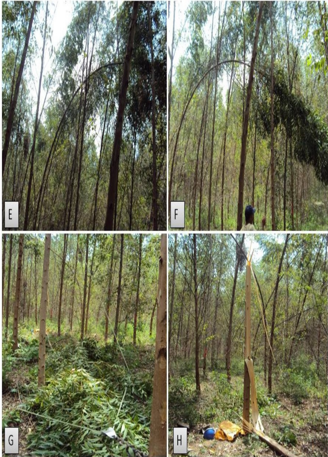
Figura 5. Etapas do teste de resistência; A) Amarrio da corda na árvore selecionada; B) Ângulo para o posicionamento do guincho motorizado; C) Manuseio da corda no motor no ato da puxada; D) Dinamômetro para aferir as forças; E) Árvore tombada devido à tração; F) Árvore tocando o solo devido à tração; G) Árvore quebrada; H) Altura de quebra da árvore.
