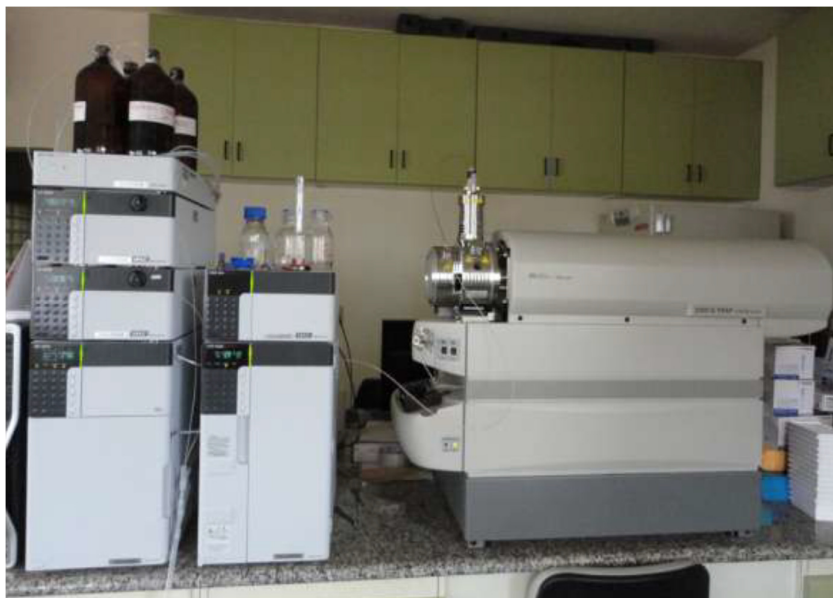
Figura 10. Cromatógrafo Líquido (Proeminence UFLC) acoplado ao espectrômetro de massas (3200 Q TRAP) – LC-MS/MS. Botucatu - SP, 2011.
