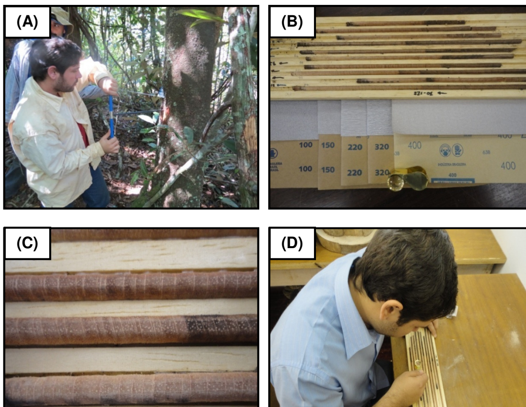
Figura 7 - procedimento para estimativa da idade das árvores de Copaifera sp.. A) retirada do cilindro de lenho com o trado de incremento; B) conjunto de cilindros, sequência de lixas e lupa de 10x de aumento; C) cilindros de lenho lixados; e D) contagem dos anéis de crescimento. Fonte: Roquette, J. G.
