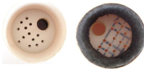
Figura 42: Polímero com os orifícios e antecâmara revestida com material fonoabsorvente.
