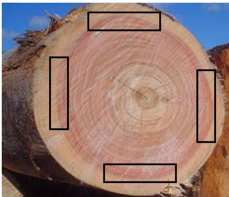
FIGURA 6 -SEÇÃO TRANSVERSAL DE UMA TORA: POSIÇÃO DA RETIRADA DAS TÁBUAS.
