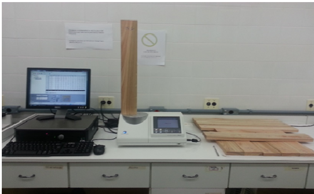
FIGURA 13 - MEDIÇÃO DA COR POR ESPECTROFOTÔMETRO CM-5 DE BANCADA ACOPLADO A UM MICRO-COMPUTADOR.
