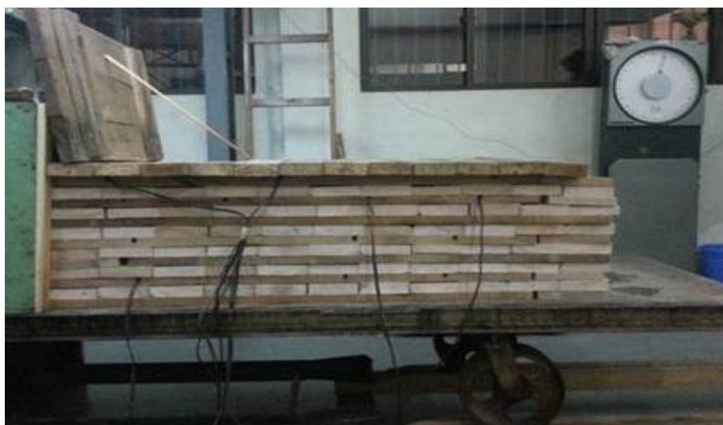
FIGURA 10 - FORMAÇÃO DA CARGA NO CARRO PARA SECAGEM.
