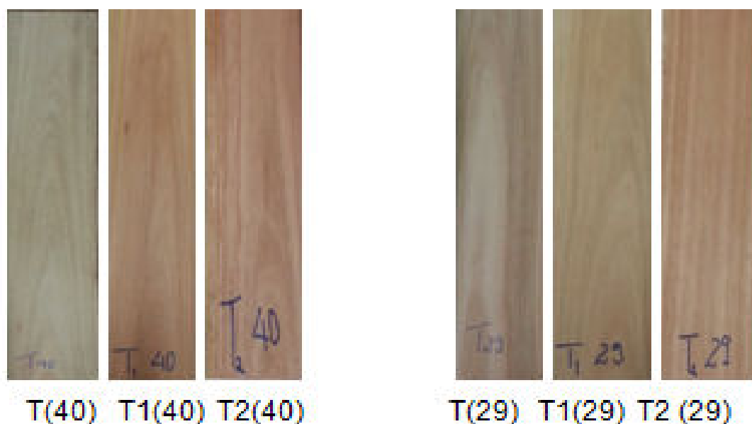
FIGURA 22 - REPRESENTAÇÃO VISUAL DA COR DA MADEIRA DE Eucalyptus saligna DA TESTEMUNHA, T1 E T2.
