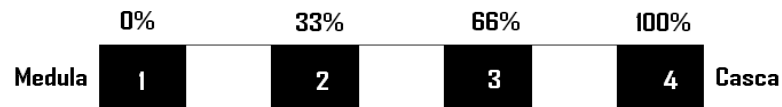
Figura 5 - Esquema das posições 1, 2, 3 e 4 de retirada dos corpos de prova da bagueta para realização das análises de densidade básica e anatomia no sentido medula-casca. Fonte: O autor.
