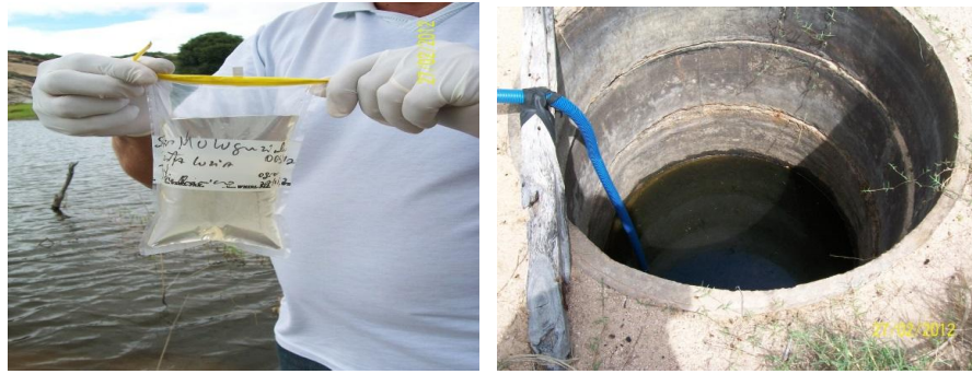
Figura 01– Coleta de água na barragem do Mulunguzinho (a) e em poço amazonas (b) Picture 01 – Water collection at Mulunguzinho dam (a) and in amazonas well (b)
