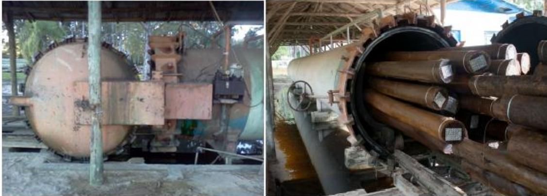
Figura 11 – Autoclave de tratamento de madeira na Unidade de Preservação da Madeira localizada no município de Capivari do Sul.
