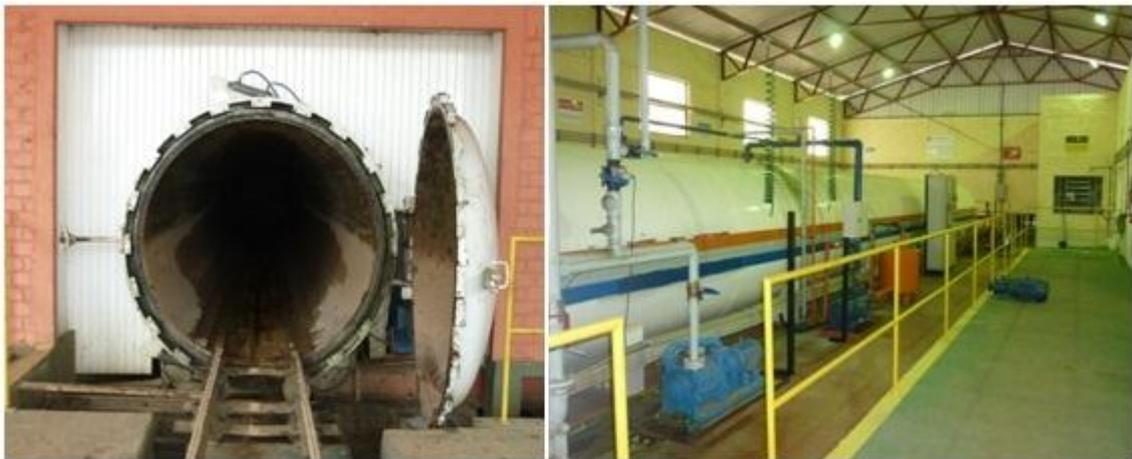
Figura 10 – Autoclave de tratamento de madeira na Unidade de Preservação da Madeira localizada no município de Charqueadas.
