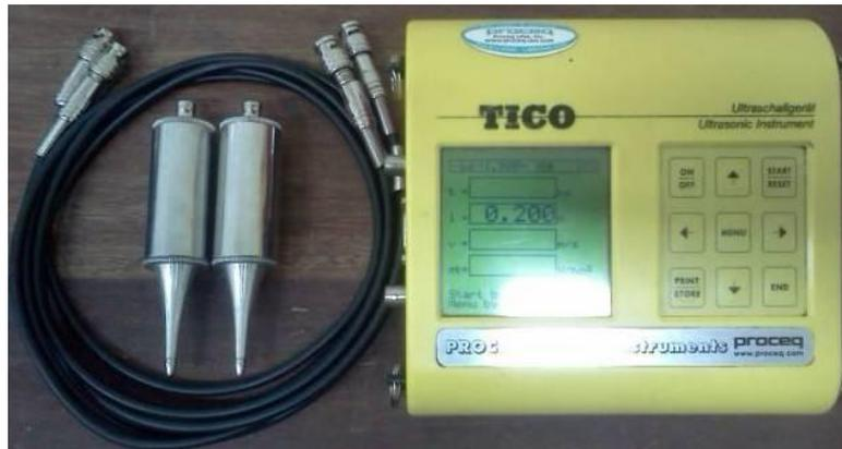
Figura 2 – Aparelho de emissão de ondas de ultrassom, cabos e transdutores de pontos secos (Fonte: autor).
