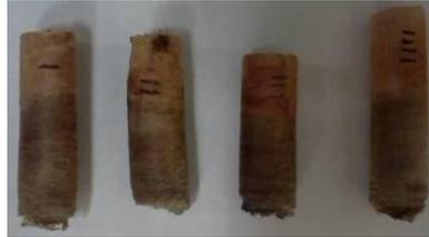
Figura 12 – Baguetas retiradas para análise de penetração e retenção de CCA-C
