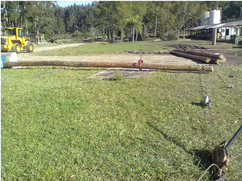
Figura 5 – Ensaio de flexão estática de postes de madeira conforme a norma NBR 6231 (ABNT, 1980) (Fonte: autor).
