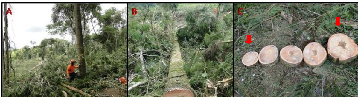
FIGURA 4 - Coleta das amostras de madeira (discos do tronco) pelo método destrutivo. Seleção do indivíduo (A), abate (B) e seções transversais do fuste de Araucaria angustifolia (C), mostrando (setas) os discos da base e do último verticilo vivo utilizados nas análises.
