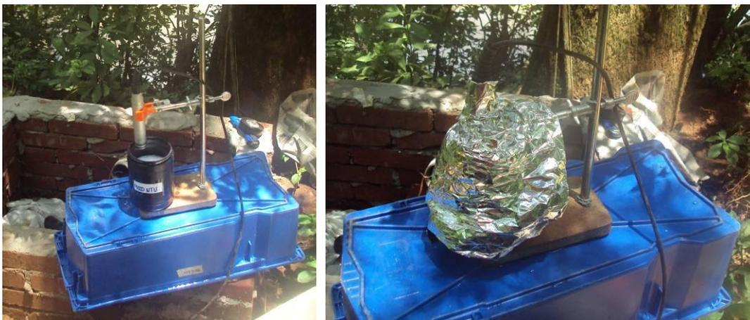
Figura 17: Calibração do sensor de turbidez com solução padrão.
