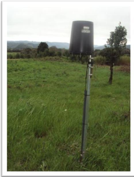
Figura 13: Pluviógrafo
