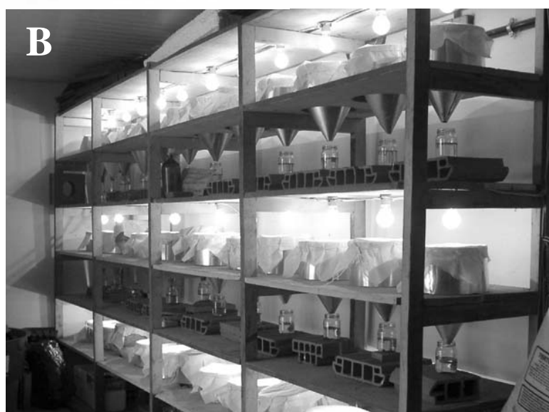
Figura 5. Funis extratores de Berlese-Tullgren. A – Esquema geral do equipamento; B – visualização do equipamento utilizado neste trabalho.
