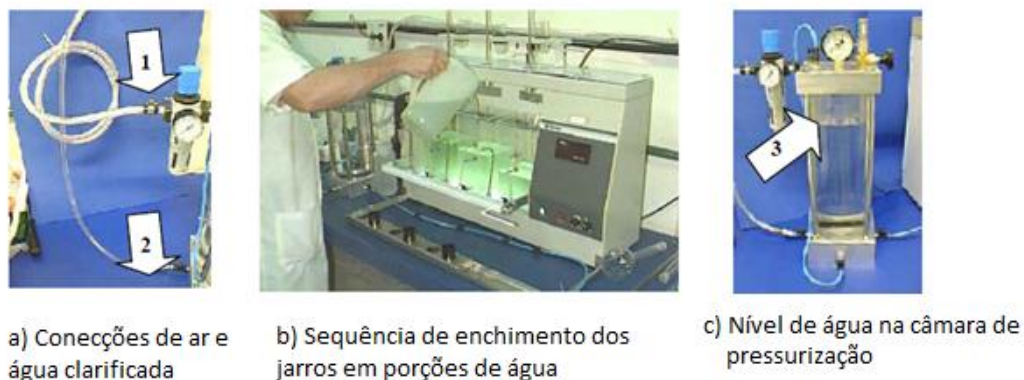
Figura 14 – Equipamento flotatest – flotador de laboratório mostrando detalhes das conexões de ar, água, sequência de enchimento e nível de água. Fonte: Autoria própria (adaptado do catálogo do equipamento).
