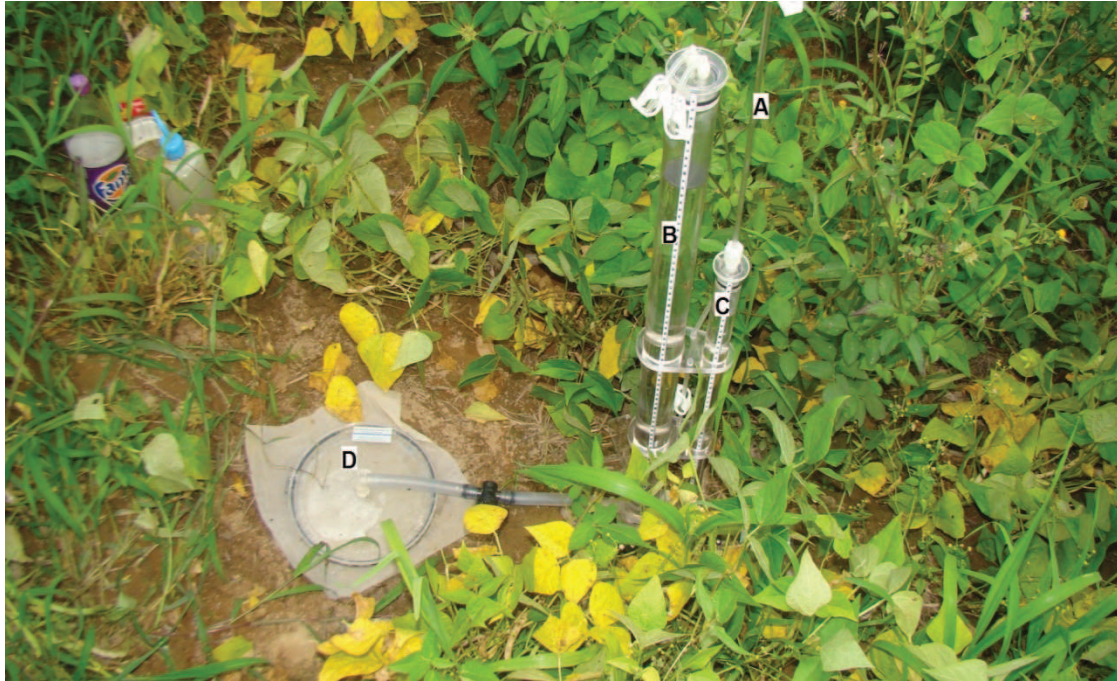
Figura 05. Infiltrômetro de tensão. A) Vareta de tensão; B) Torre de água; C) Torre de bolha; D) Disco de infiltração. Fonte: Autor
