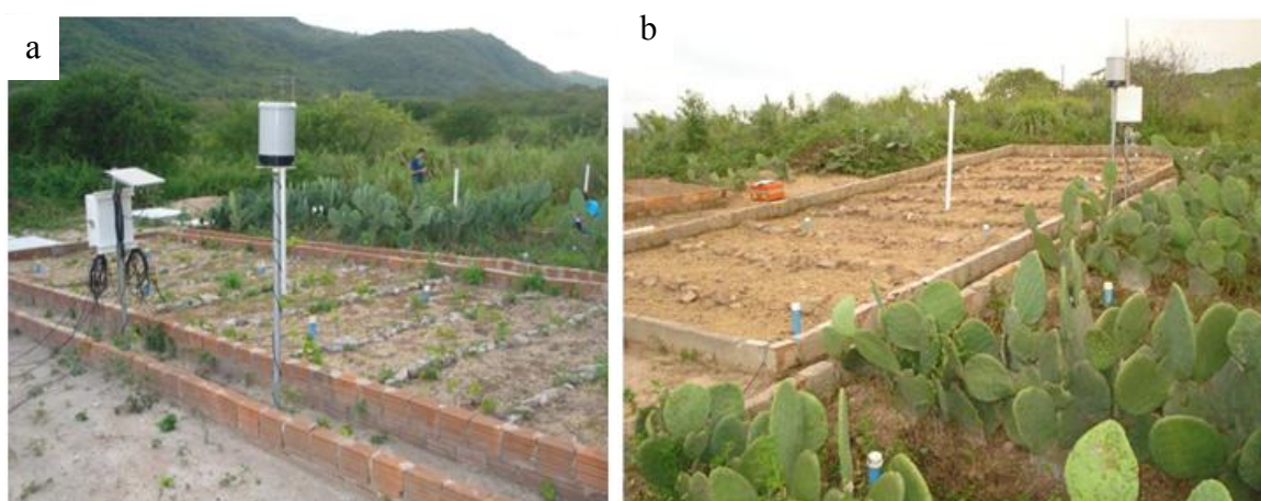
Figura 6. Áreas experimentais I (a) e II (b) onde as parcelas experimentais estão instaladas, dotadas de sondas TDR e de pluviógrafo automático.
