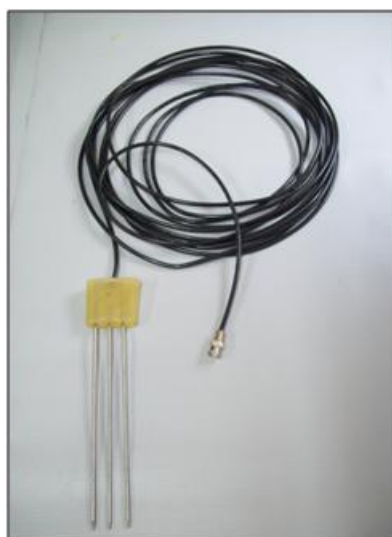
Figura 4. Sonda TDR confeccionada em laboratório.
