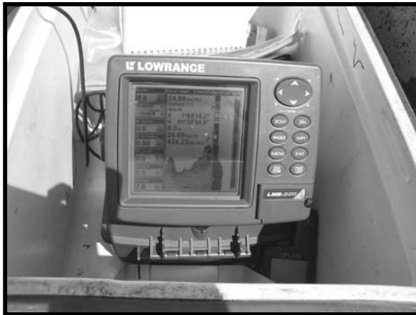
Figura 3.6. Ecobatímetro digital com GPS acoplado.
