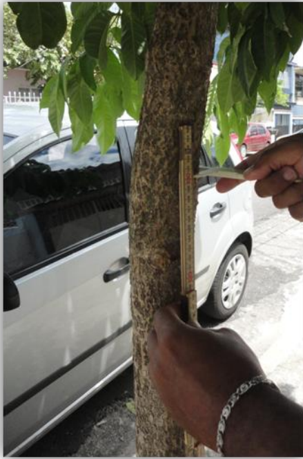
Figura 4 - Diâmetro de tronco a altura do peito (DAP), mensurados com o auxílio de paquímetro.
