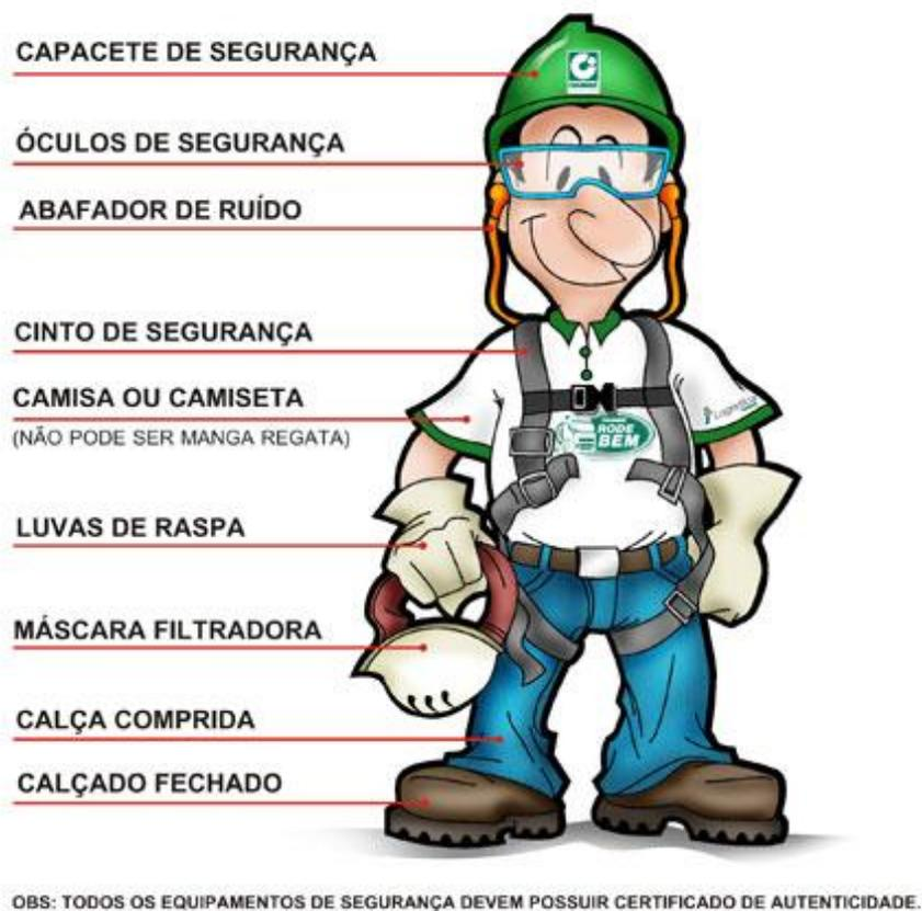
Figura 2: Exemplos de Equipamentos de Proteção Individual. (Fonte: SEGTRABTST. BLOGSPOT, 2010).
