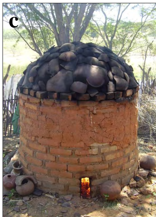
Figura 15. Etapa de cocção. (a) Uma ceramista e seu esposo com o seu forno para queima de “loija”; (b) Peças arranjadas no forno antes de serem cobertas com “cacos”; (c) O forno em atividade coberto por “cacos” de panelas quebrados. Fotos: (a) Ângelo Alves; (b) Sérgio Bernardo; (c) Raiana Lira
