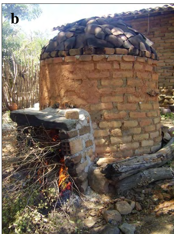
Figura 16. Etapas de cocção. (a) Os recursos vegetais usados na “queima” envolvem diferentes diâmetros de madeira; (b) Para esquentar o forno é adicionado “garrancho” (madeiras com menor diâmetro); (c) A etapa de “cardear” requer a adição de “lenha” (madeiras com menor diâmetro). Fotos:Raiana Lira
