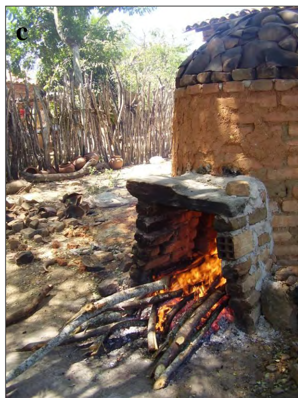
Figura 16. Etapas de cocção. (a) Os recursos vegetais usados na “queima” envolvem diferentes diâmetros de madeira; (b) Para esquentar o forno é adicionado “garrancho” (madeiras com menor diâmetro); (c) A etapa de “cardear” requer a adição de “lenha” (madeiras com menor diâmetro). Fotos:Raiana Lira
