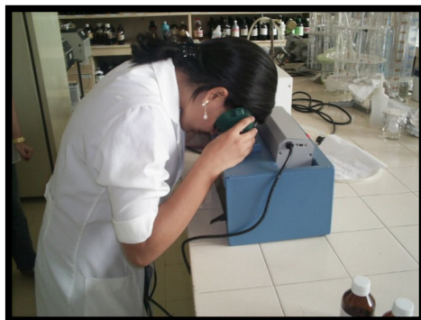
Fig. 20 – teste para cumarina observado em câmara escura com lâmpada ultravioleta.
