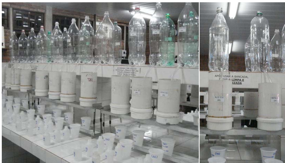
Figura 2. Disposição das colunas sobre suporte metálico na posição vertical para o experimento de lixiviação de Pb por agentes quelantes (ácidos cítrico e oxálico, EDTA e NTA).
