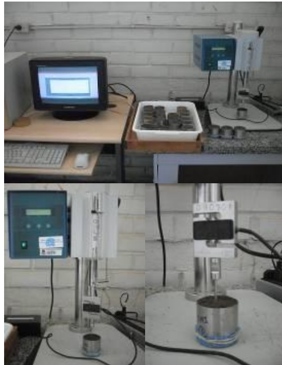
Figura 7. Determinação da resistência do solo à penetração das raízes.
