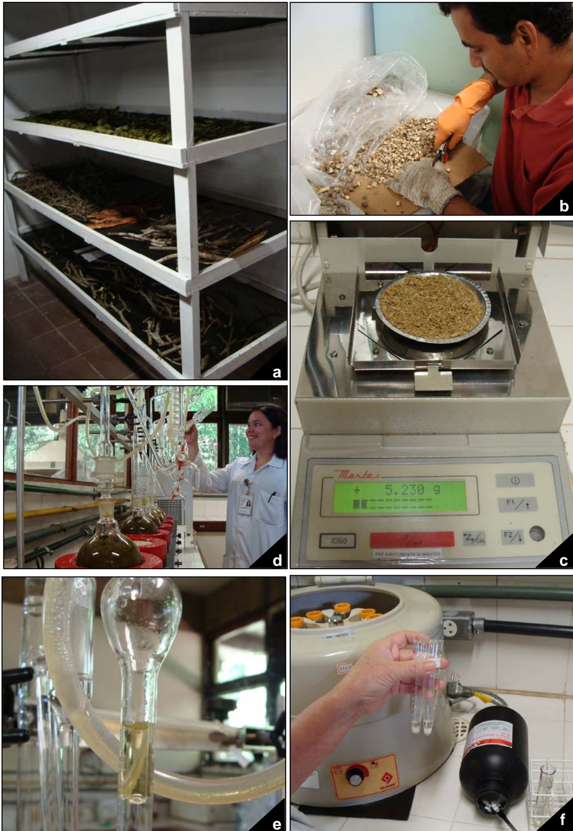
Ilustração 1. Principais etapas desenvolvidas para a extração do óleo essencial por Hidrodestilação. a) secagem do material botânico; b) preparo do material para trituração; c) equipamento utilizado para verificação do teor de água do material botânico; d) Hidrodestilação; e) detalhe do óleo essencial extraído; f) separação do óleo essencial da água.
