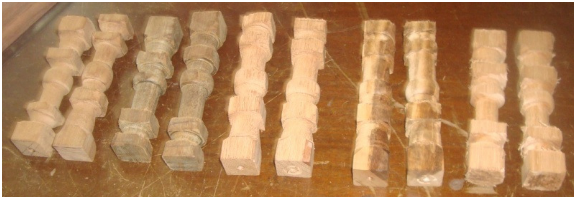
Figura 8. Corpos-de-prova depois da realização do teste de torno. Da esquerda para a direita, as espécies canela, ipê, angelim, muiracatiara e cedro, respectivamente.
