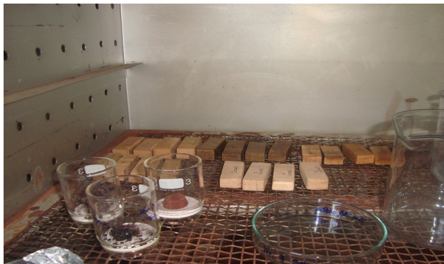
Figura 3. Corpos-de-prova na estufa a 103 \pm 2 °C.
