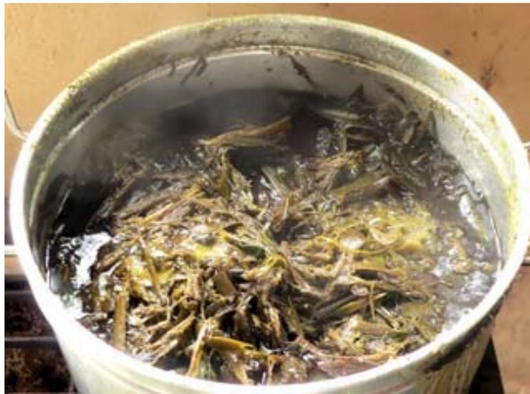
**Figura 38.** Deixe cozinhar até as fibras começarem a se soltar. Em alguns processos o tempo de cozimento pode ser entre 02 a 04 horas. Se necessário acrescente mais água. A função do cozimento com a adição de um álcali é retirar a lignina entre outros extrativos vegetais presentes nas fibras que não são necessários na fabricação do papel.
