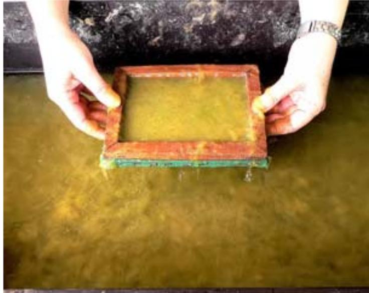
**Figura 53.** Retire a tela verticalmente e permaneça com ela paralela para que a água escorra. Caso a tela fique inclinada quando ainda tiver muita água nas fibras as mesmas podem se deslocar para o lado da inclinação e o papel ficará com um lado com maior concentração de polpa do que o outro, ou seja, ficará mais grosso de um lado.
