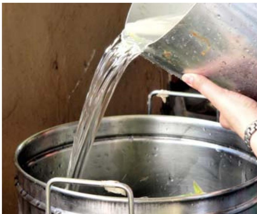
**Figura 36.** Adiciona-se água. Pela alta umidade da planta em uma panela com capacidade para 20 L acrescenta-se junto às fibras no máximo 10 L de água.
