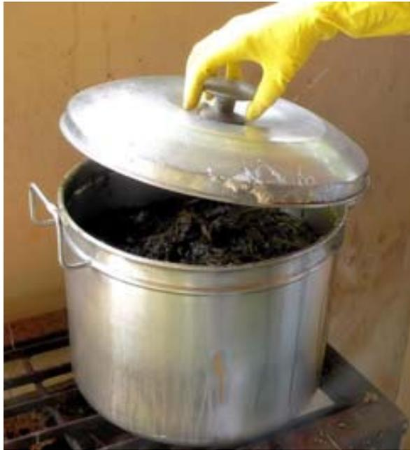
**Figura 39.** Depois que a fibra estiver cozida desligue o fogo e espere a solução (ou licor) esfriar.
