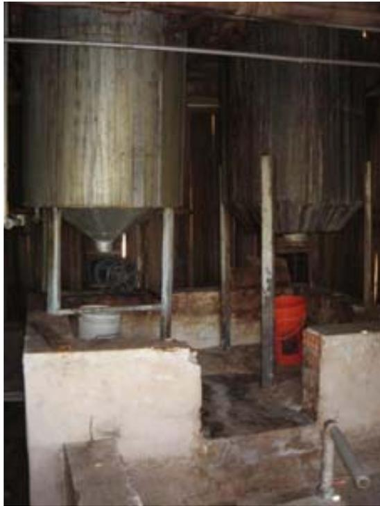
**Figura 15.** Dois cozinhadores que são alimentados pelo vapor da caldeira, usados no processamento das fibras.
