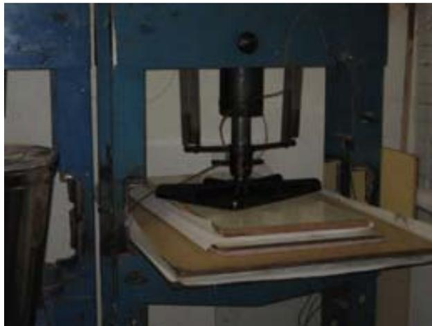
**Figura 60.** Depois de formadas todas as folhas desejadas leve a pilha de entretelas para uma prensa. Acondicione as entretelas entre duas tábuas forradas com fôrmica. Prende para retirar o excesso de água.
