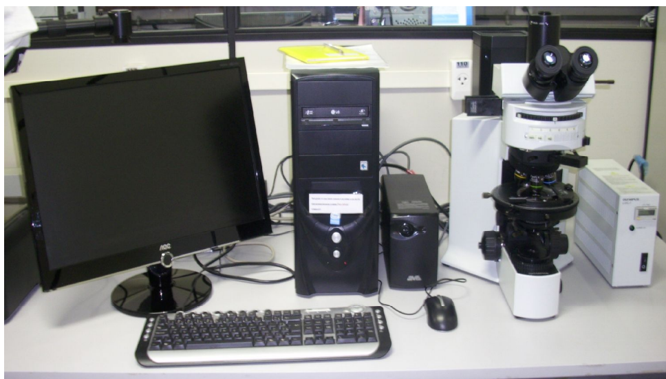
Figura 5. Microscópio óptico Olympus , acoplado a um sistema de análise de imagem digital (Imaging Software cell f ) utilizado para a microscopia de campo claro e epifluorescente.
