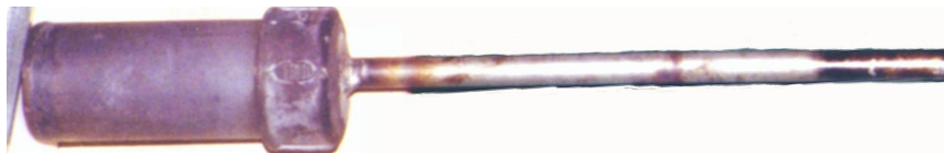
Figura 1 - Cadinho metálico, usado para a destilação seca dos materiais vegetais.
