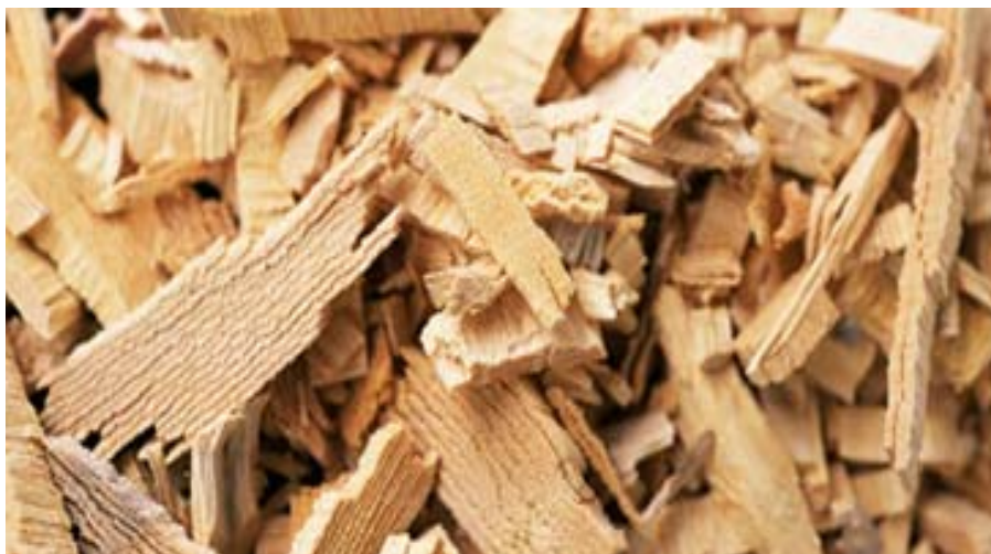
Figura 3. Partículas utilizadas na produção do OSB (cortadas no sentido longitudinal às fibras). Fonte: CICHINELLI, 2005 – www.portalosb.com.br
