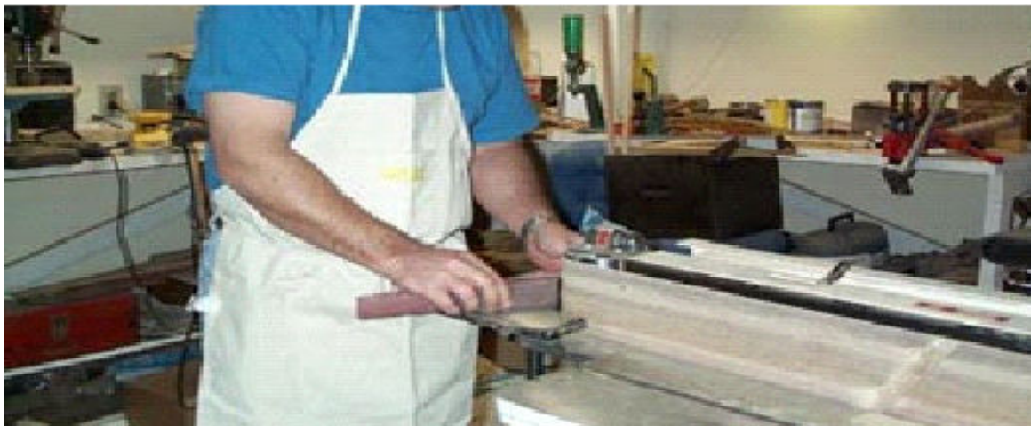
Figura 7. Lixamento das partes do arco (Renegade Archery, 2008)
