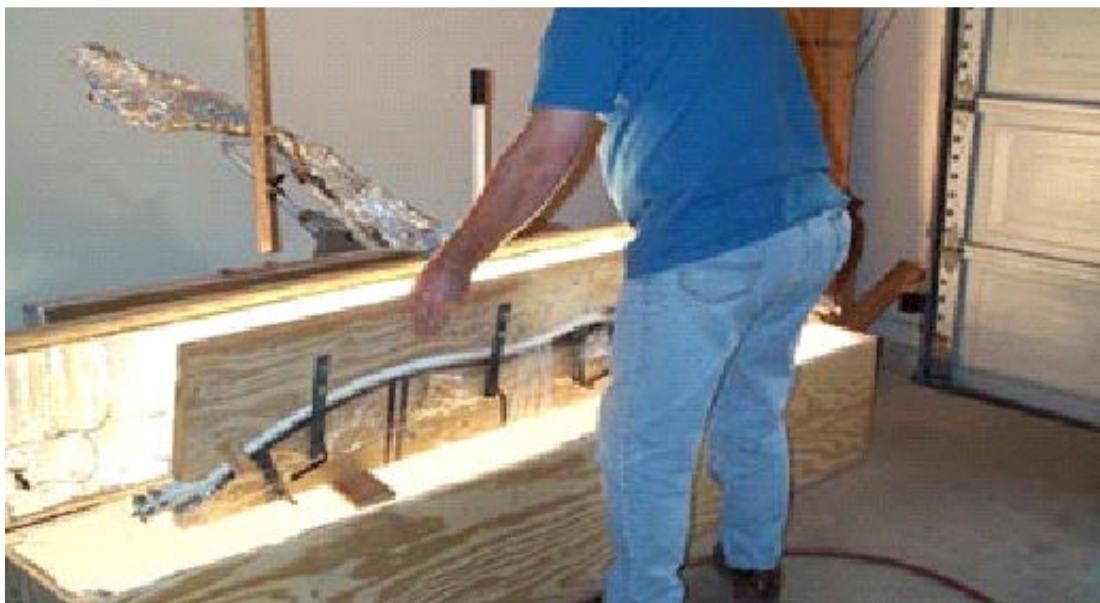
Figura 9. Exemplo de fôrma e de estufa para secagem do material (Renegade Archery, 2008)
