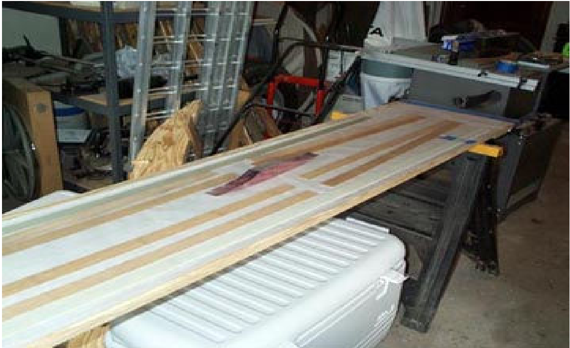
Figura 8. Peças limpas, prontas para o processo de colagem (Renegade Archery, 2008)
