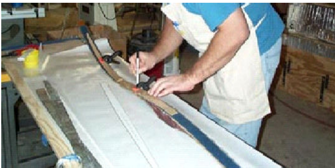
Figura 10. Marcação dos pontos para ajustes (Renegade Archery, 2008)
