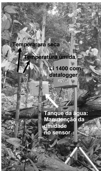
Figura 6. Esquema de instalação de sensores em clareira. Li1400, Temperatura seca/úmida
