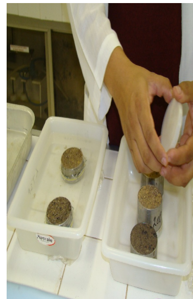
Figura 1. Perfil de solo amostrado (A); amostras indeformadas em cilindro volumétrico para determinação da densidade do solo (B); preparação das amostras para determinação da densidade (C)
