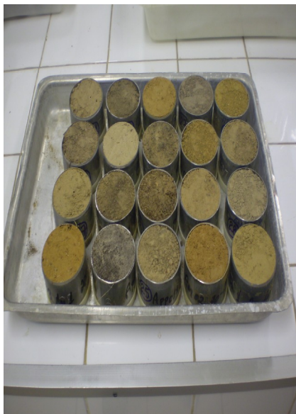
Figura 1. Perfil de solo amostrado (A); amostras indeformadas em cilindro volumétrico para determinação da densidade do solo (B); preparação das amostras para determinação da densidade (C)
