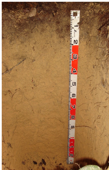
Figura 1. Perfil de solo amostrado (A); amostras indeformadas em cilindro volumétrico para determinação da densidade do solo (B); preparação das amostras para determinação da densidade (C)
