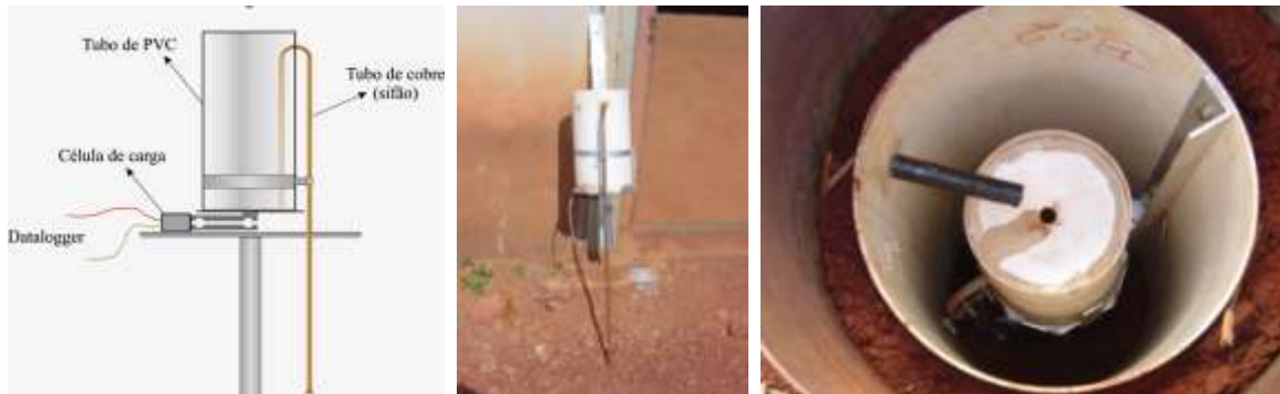
Figura 4.6 - Sistema de coleta, armazenamento e pesagem da água captada pelas calhas de escoamento superficial e drenagem da Estação Olhos d'Água.
