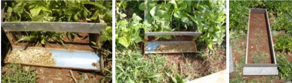
Figura 4.4 - Detalhamento do sistema de captação de água das calhas de escoamento superficial.
