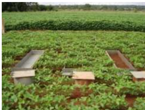
Figura 4.3 - Três calhas de monitoramento do escoamento superficial sob diferentes condições de cobertura (fechada, com vegetação e com solo nu).
