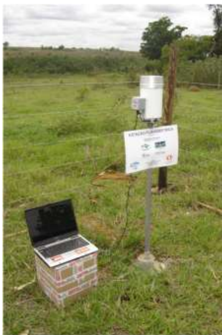
Figura 4.21 - Estação automática de monitoramento da chuva na Bacia Experimental do Alto Rio Jardim (Estação Chácara 100).
