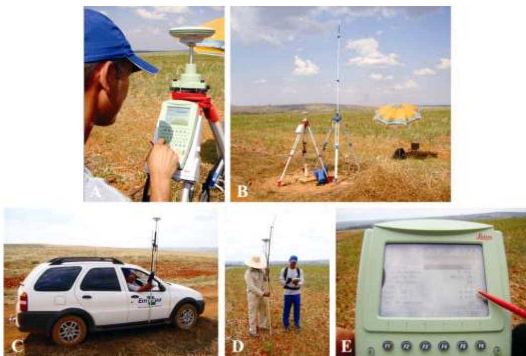
Figura D.3 - Esquema do levantamento de dados utilizando o DGPS.
