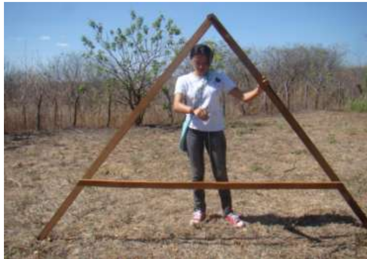
Figura 4: Declividade da área 1(A1) sendo medido com o pé de galinha.
