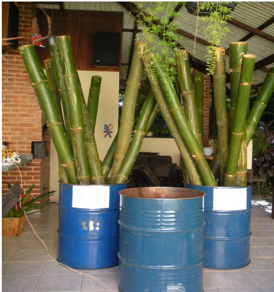
Figura 3 – Peças em tratamento pelo método de substituição de seiva.
