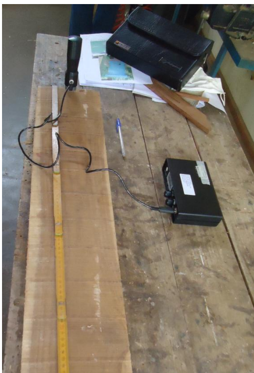
Figura 4 – Determinação da umidade da tábua de teca com a utilização do aparelho medidor elétrico DL 822 – Digisystem
