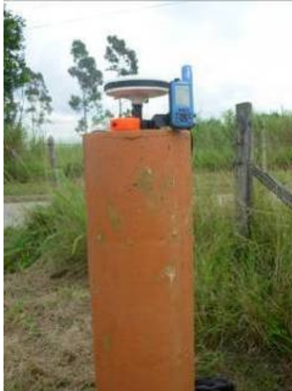
Figura 04: Receptores DGPS no marco geodésico da UFRRJ.
