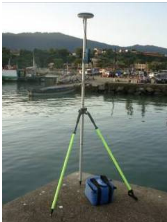
Figura 05: Receptores DGPS em modo cinemático disposto no entreposto pesqueiro da Ilha da Madeira.
