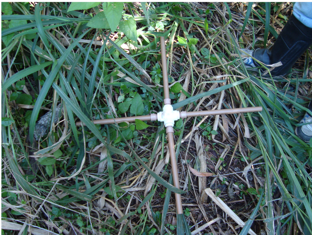
Foto 12: Cruzeta utilizada para o levantamento fitossociológico de acordo com o Método de Distância denominado Ponto por Quadrantes
