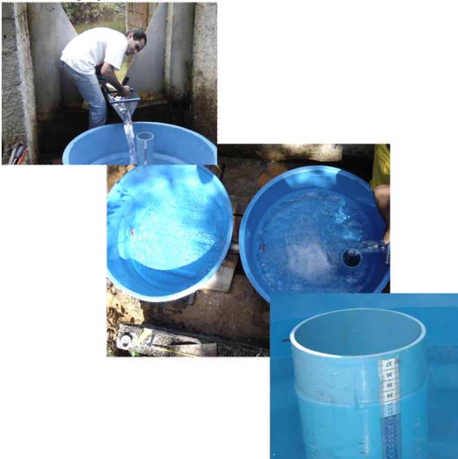
Figura 06 - Calibração do vertedor triangular.
