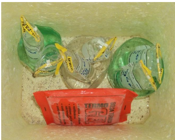
Figura 3: Coleta de água (A), acondicionamento das amostras para o transporte até o laboratório (B). Fotos do Autor
