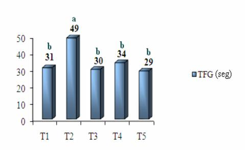
**Figura 3.** Valores médios de tempo de formação de gel (seg) – TFG para os diferentes tratamentos. T1= acácia negra 45%; T2= *P.oocarpa* 45%; T3= acácia: pinus 70:30; T4= acácia:pinus 80:20; T5= acácia:pinus 90:10. Letras iguais não diferem estatisticamente entre si, ao nível de 95% de probabilidade, pelo teste de Tukey.
