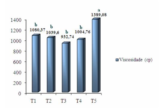
**Figura 2.** Valores da viscosidade média para os diferentes tratamentos. T1= acácia negra 45%; T2= *P.oocarpa* 45%; T3= acácia: pinus 70:30; T4= acácia: pinus 80:20; T5= acácia: pinus 90:10. Letras iguais não diferem estatisticamente entre si, ao nível de 95% de probabilidade, pelo teste de Tukey.
