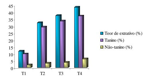
**Figura 1.** Valores médios dos teores de extrativos (%), rendimento em taninos e não-taninos (%) dos extratos da casca de *P.oocarpa*. T1 = extração com água; T2 = extração com 6% Na<sub>2</sub>SO<sub>3</sub>; T3=extração com 8% Na<sub>2</sub>SO<sub>3</sub>; T4= extração com 10% Na<sub>2</sub>SO<sub>3</sub>.
