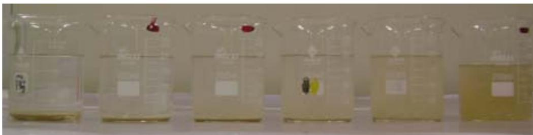
Figura 1: Amostras de água tratada com 200, 175, 150, 125 e 100 mg/L de extrato de sementes de *Moringa oleifera* e de água bruta (à direita).
