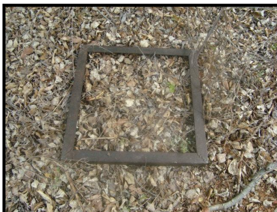
Figura 4 □ Moldura metálica utilizada para coleta da serapilheira acumulada.
