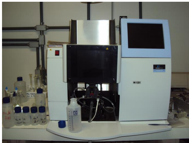
Figura 9. Espectrofotômetro de Absorção Atômica (AAS)
