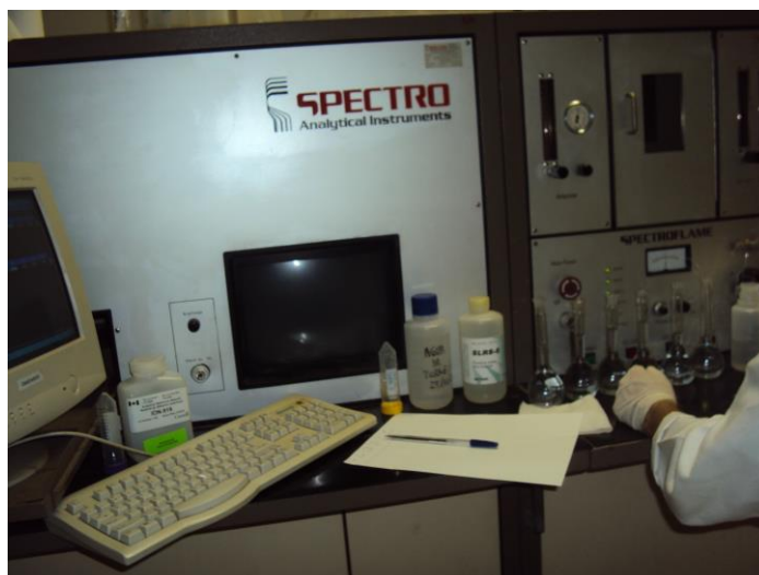
Figura 10. Espectrômetro de Emissão Atômica com fonte de plasma de argônio (ICP-AES)
