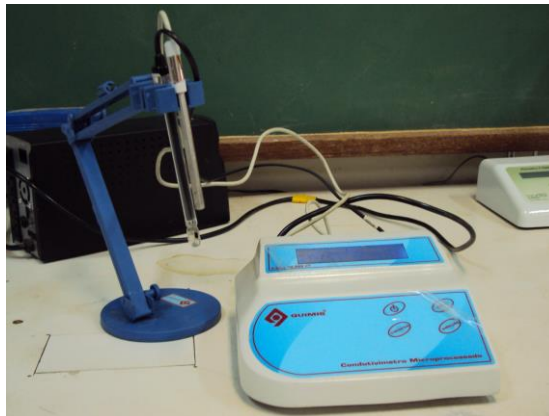
Figura 7. Condutímetro de bancada usado para medição da condutividade elétrica.
