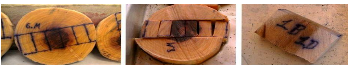
Figura 5 – Identificação dos discos e corpos de prova.
