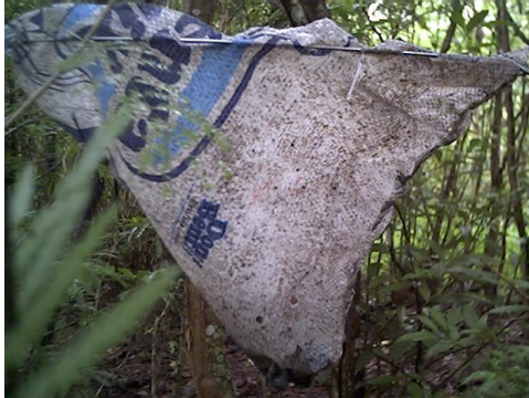
Figura 1 - Coletor utilizado para quantificação do material formador da serrapilheira
