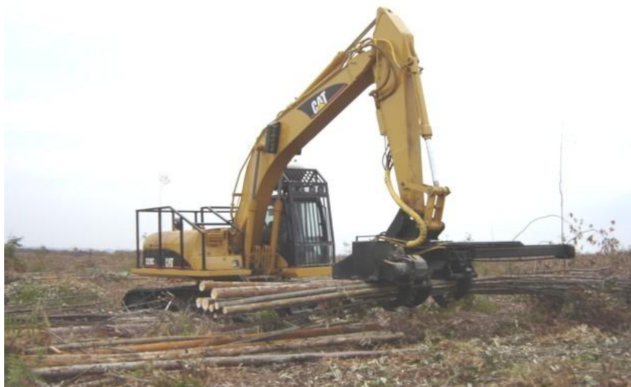
Figura 4. Máquina base Caterpillar 320 CL equipada com Processador Florestal.
